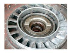
Figure 5.44 Impeller
